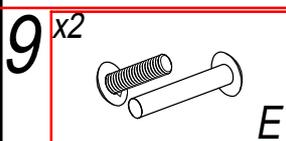
Для соединения данного стеллажа стяжками-гильзами со шкафом для одежды П049.104 необходимо предварительно досверлить отверстия на стенках боковых шкафа и стеллажа (используя сквозное сверло диаметром 5 мм).
