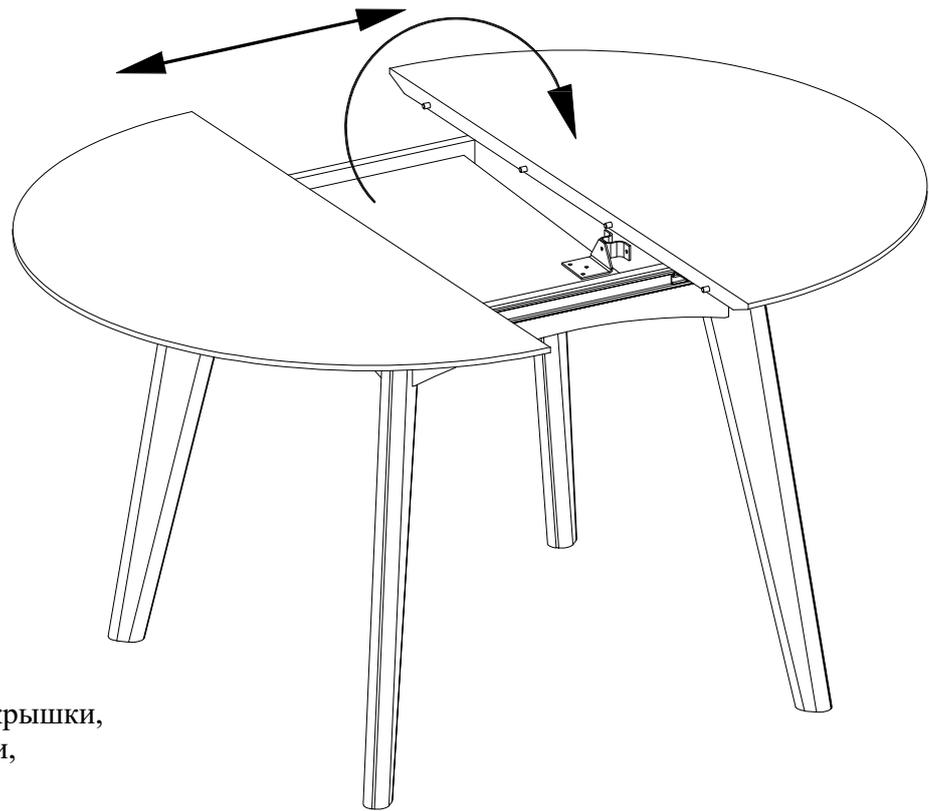
1. Раздвиньте максимально полукрышки, предварительно повернув крючки, которые фиксирует полукрышки.
