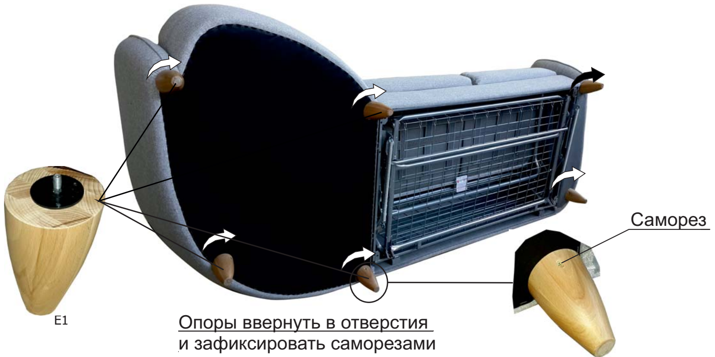
Схема расположения опор
