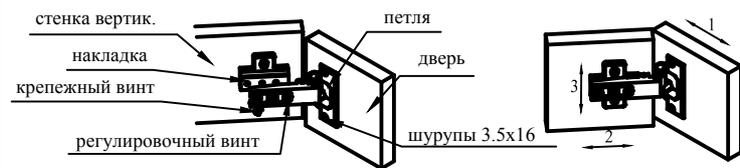
1. Регулирование смещения двери по ширине : ослабьте крепежный винт, регулировочный винт поверните вправо (зазор больше) либо влево (зазор меньше), после чего снова затяните крепежный винт.
