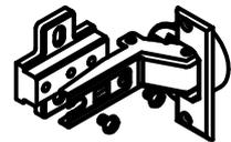
Установка дверного амортизатора
