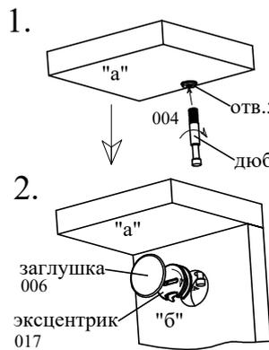
1. Закрутите дюбель в отверстие диаметром 5 мм в пласте детали
