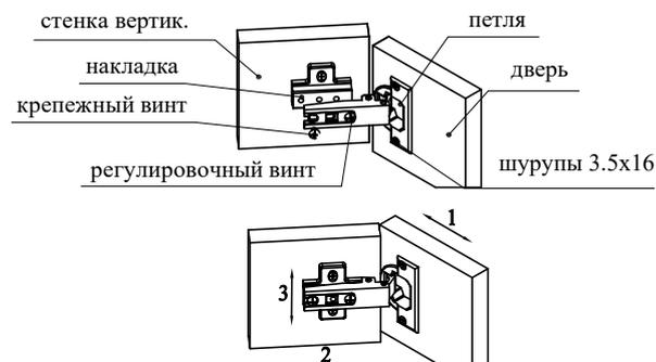
1. Регулирование зазора между корпусом и дверью: ослабьте крепежный винт, регулировочный винт поверните вправо (зазор больше) либо влево (зазор меньше), после чего снова затяните крепежный винт.
